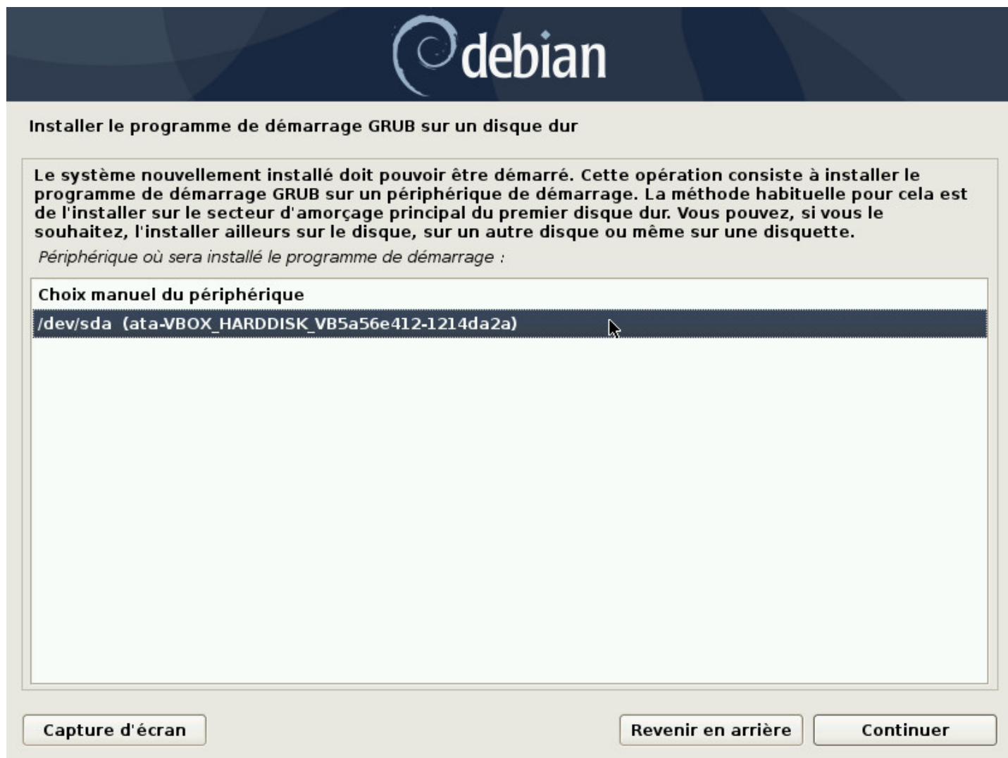
Installation : choix du disque pour GRUB
